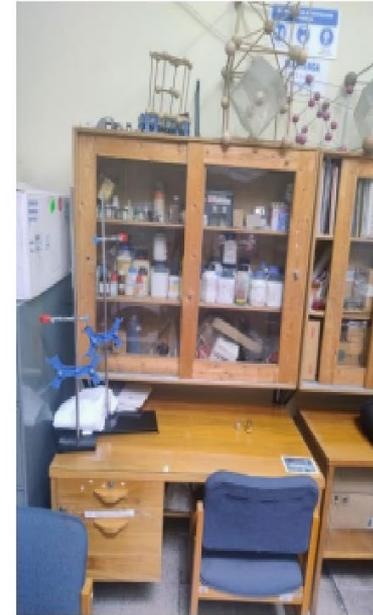
Laboratorio 121A. Resonancia Paramagnética Electrónica. Ausencia de estándares de Seguridad en almacenamiento de Sustancias Químicas. Ausencia de implementación de parámetros de SGA
