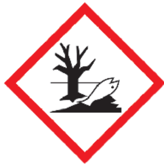
DAÑO AL MEDIO AMBIENTE
